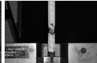
Ispitivanje materijala: tlačna proba betonskog valjka i vlačna proba čelične šipke
