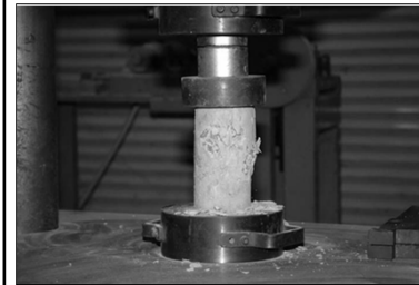
Ispitivanje materijala: tlačna proba betonskog valjka i vlačna proba čelične šipke
